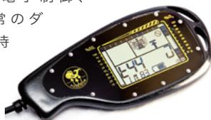
深度に応じた適切な酸素濃度を全自動でコントロールする為、体にも負担をかけずに潜水可能時間を飛躍的に延長する事ができます。
